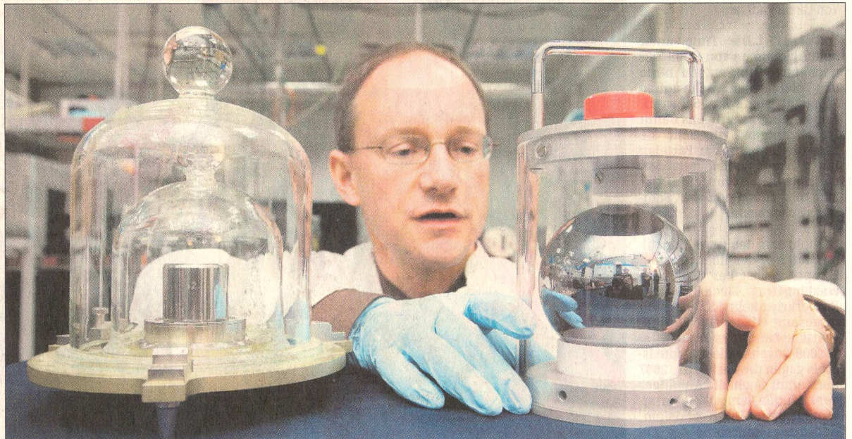
Alt und neu: Der Wissenschaftler Arnold Nicolaus von der Physikalisch-Technischen Bundesanstalt (PTB) stellt in seinem Institut in Braunschweig eine etwa eine Million Euro teure, etwa zehn Zentimeter dicke Kugel aus Silizium neben eine Kopie des Ur-Kilogramms aus Platin und Iridium. (Foto: dpa)
