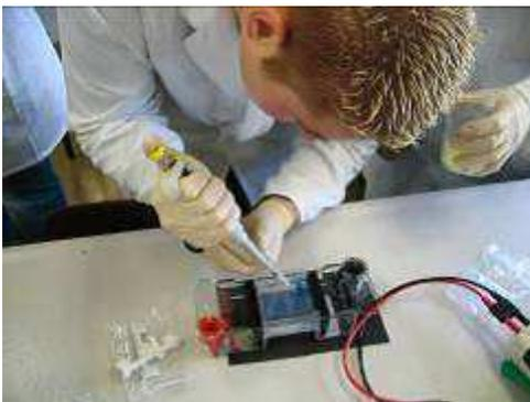
Beladen des Elektrophoresegels für die Restriktionsanalyse
